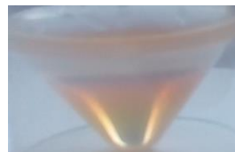
Rys. 6. Odczyn Salkowskiego (reakcja chloroformowego ekstraktu cholesterolu (z żółtka jajka kurzego) ze stężonym H_2SO_4 )
